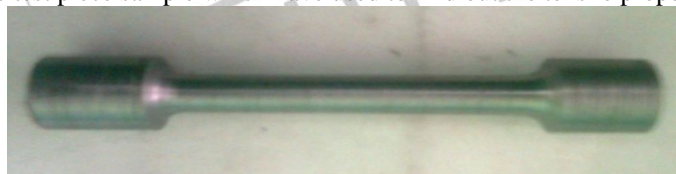
Fig.11: Tensile test piece
