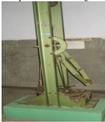
Fig.7: Izod test machine
