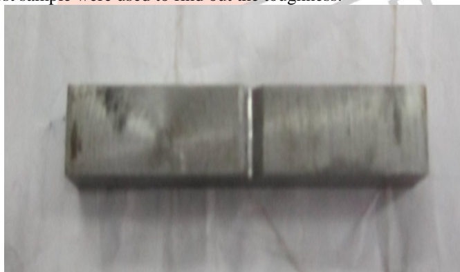
Fig.14: Izod test piece
