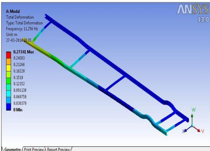
Fig 4.2 Deformation 1<sup>st</sup> Mode
