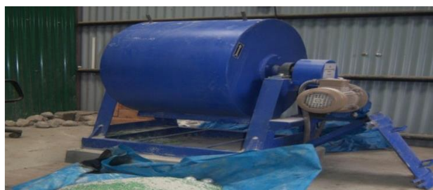
Fig 2: Los angles abrasion machine
